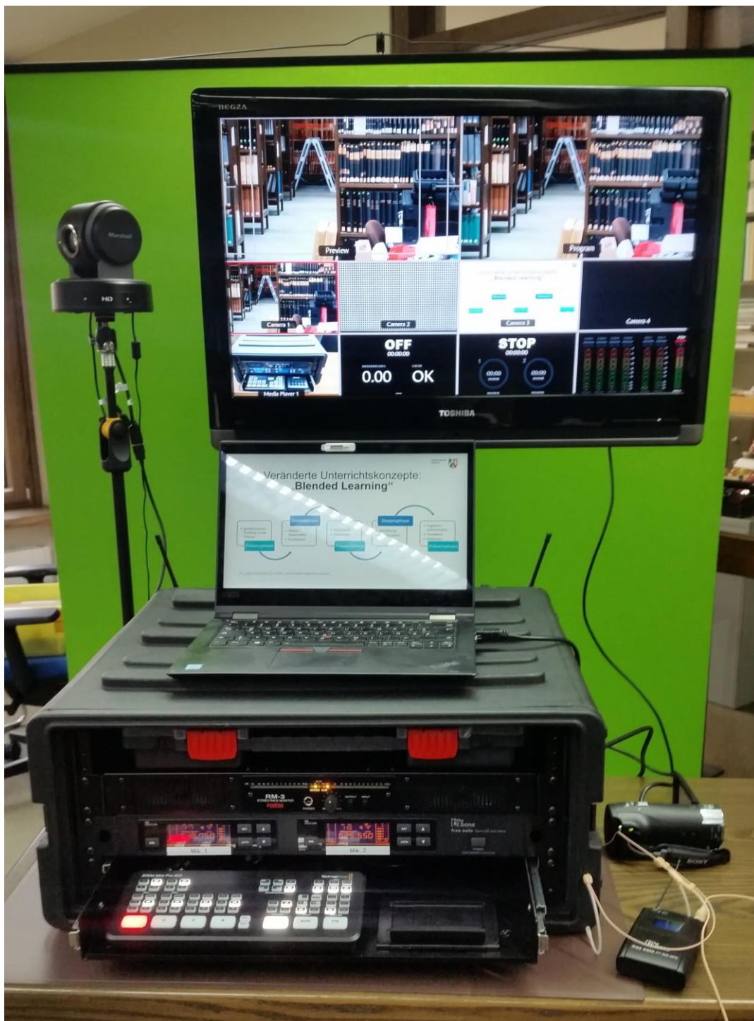
Abb. 15: Die fertig aufgebaute VIDEOBOX in Funktion mit Notebook, Green-Screen (optional), PTZ-Kamera (links) und Handkamera (rechts) sowie einem Taschensender mit Headset. Vor dem Green-Screen ist ein 32" Display auf einem Stativ aufgestellt. Das zur Konfiguration und teilweise zur Steuerung notwendige Notebook auf der VIDEOBOX verdeckt die Stativsäule.
