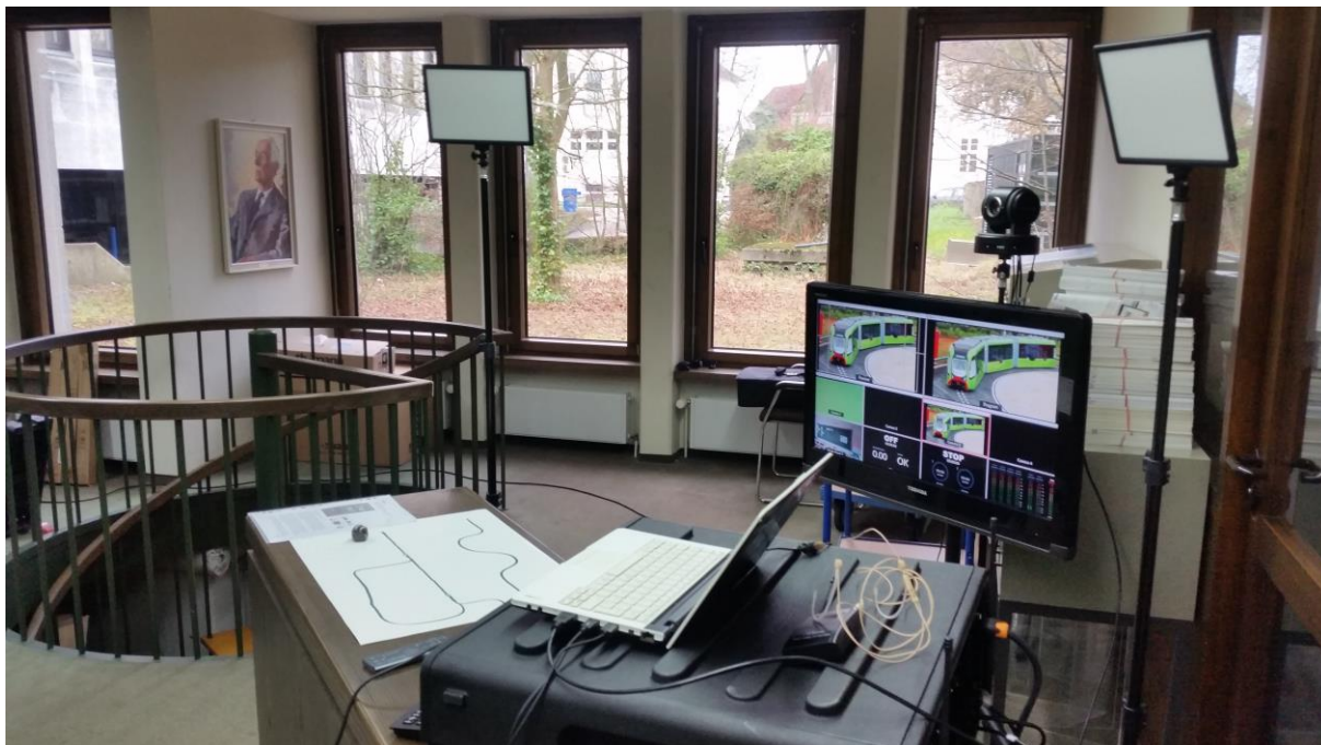
Abb. 16: Die VIDEOBOX mit allen Komponenten als mobiles Videostudio in einem Aufbau für eine Produktion. Auf den Stativen links und rechts die LED-Lichtpanels. Über dem Display die PTZ-Kamera.
