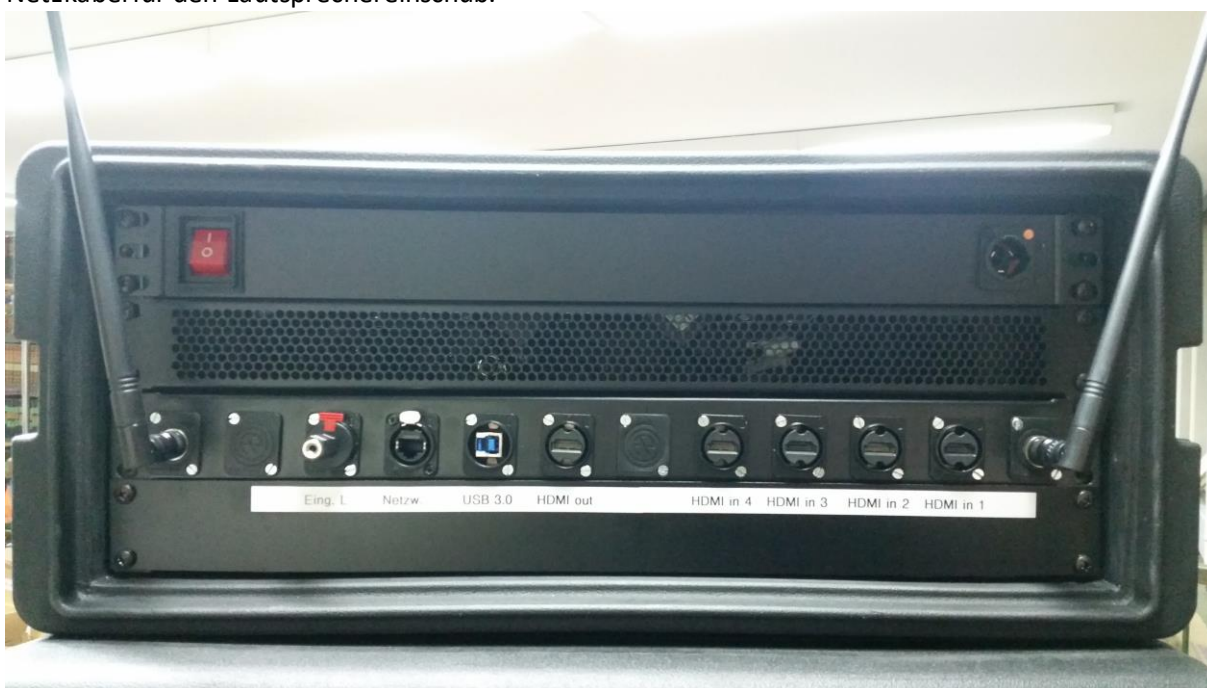
Abb. 14: Die Stromversorgungseinheit auf der Rückseite muss immer so eingebaut werden, dass der rote Netzschalter links montiert ist. Zum Schluss noch die beiden Antennen auf die rückseitigen Buchsen vorsichtig aufstecken und durch eine Vierteldrehung verriegeln, so dass sich die Antennenbuchsen nicht in sich verdrehen (ggf. die Antennenbuchse dabei mit einer kleinen Zange festhalten).
