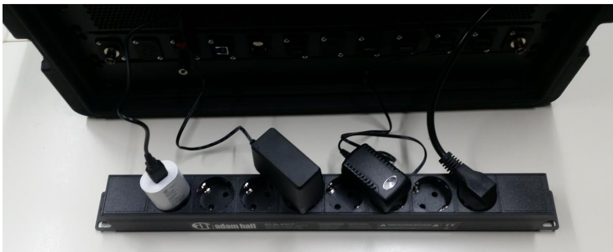
Abb. 13: Blick auf die Rückseite der Stromversorgungseinheit. Von links nach rechts: Anschluss HDMI-Adapterkästchen zur Erzeugung des Kopfhörersignals, 2 Steckernetzteile (die überkragenden Teile der Netzteile müssen immer nach unten zeigen) von Videomischpult und Doppelempfänger, 230-V-Netzkabel für den Lautsprechereinschub.
