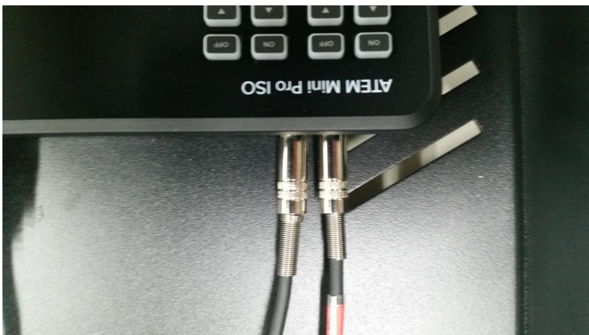
Abb. 11: Anschluss des Doppelpfängers an die Mikrofonanschlüsse des Videomischpultes. Die Anschlüsse der beiden Antennenkabel erfolgen erst, nachdem die hintere Anschlussleiste eingebaut worden ist.
