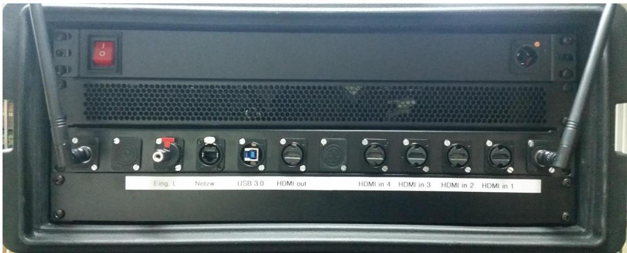
*Videobox Rückseite mit den beiden Antennen links und rechts für den UHF-Empfänger*
