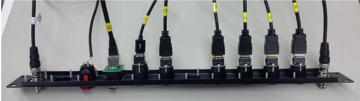
*Demontierte rückseitige Anschlussleiste*
