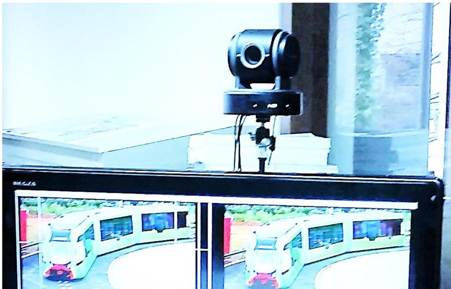
Für die Einrichtung der Kamera bitte die Anleitung heranziehen. Die Kamera stellt über das beigelegte Adapterkabel (Multipin-Anschluss, ähnlich DVI) eine HDMI-Schnittstelle zur Verfügung.
