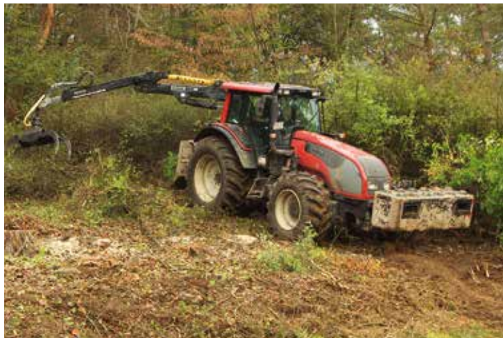
Räumung einer Entbuschungsfläche mit Hilfe eines Forstschleppers
