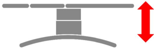
Hebemechanik verdeckt in eine oder zwei vertikale Säule(n) eingebaut (Fotos: in.signo GmbH)
