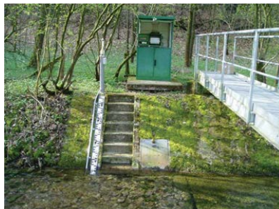
Bild 6 Abflusspegel Kohlstädt / Strothe mit abrufbarem Datenlogger EcoLog 500
