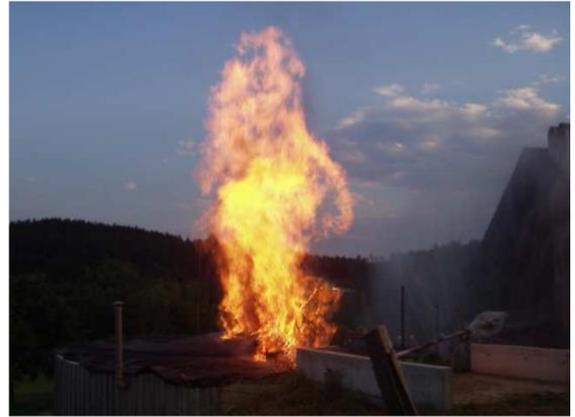
Abbildung 15: Brandversuch an einer EPDM-Folie
