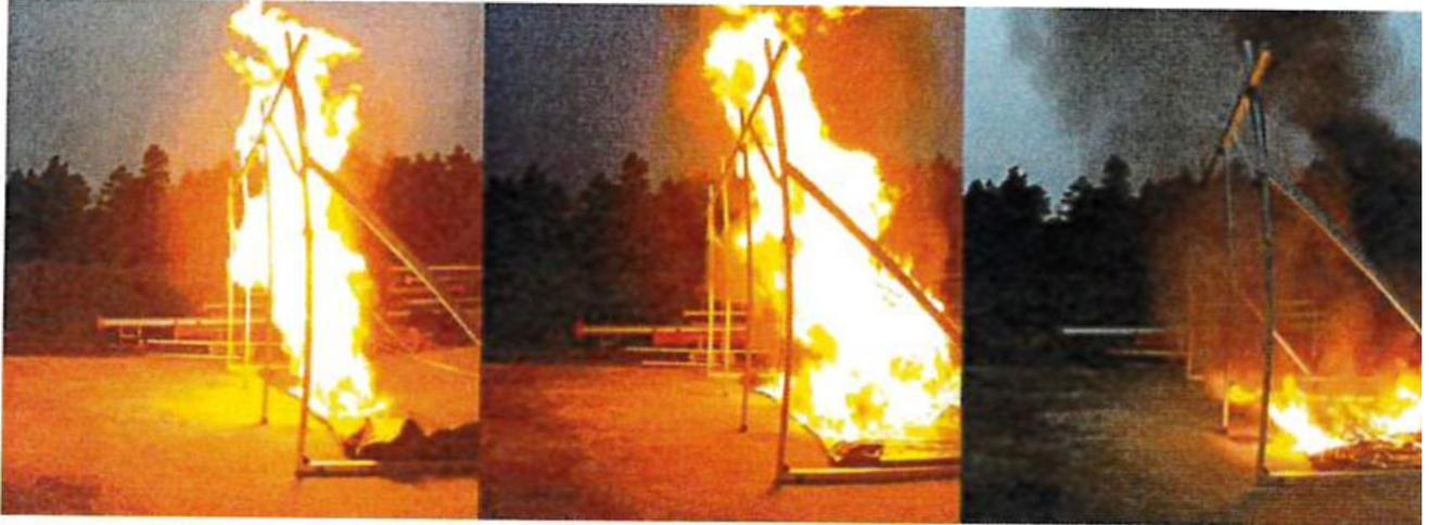
**Bild 10** Aufnahmen des Brandverhaltens der Biogasfolie.
