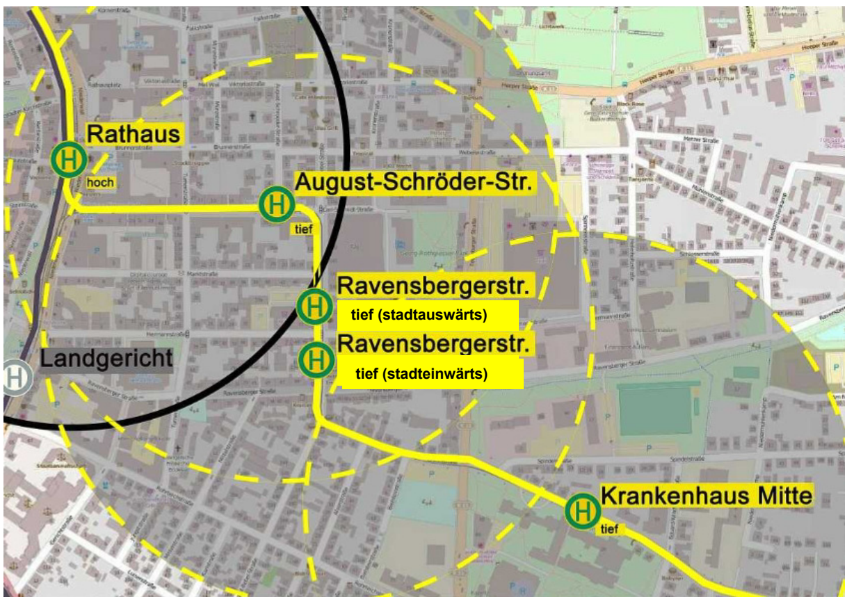
Abbildung 1: Einzugsbereiche der Haltestellen im Ist-Zustand ( r=400\text{ m} )
