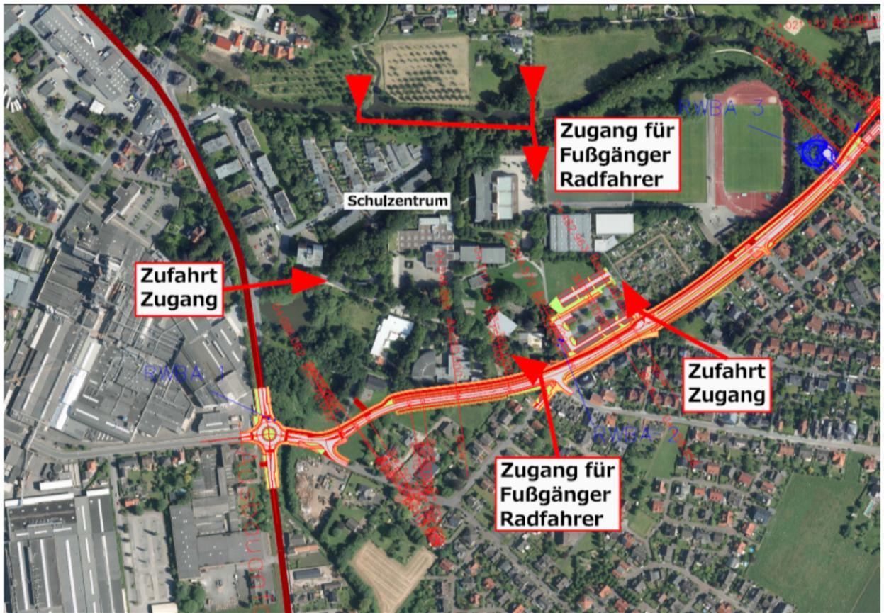
Im Bereich der Querung Burgweg ist die Einrichtung einer bedarfsgeregelten Lichtsignalanlage vorgesehen, da hier mit einer starken Frequentierung durch Schüler zu rechnen ist und somit eine verkehrssichere Querung der Fahrbahn ermöglicht wird. Bei den anderen Querungsmöglichkeiten ist die Anlage von Bedarfsampeln optional vorgesehen. Hierzu werden im Zuge der Baumaßnahme die erforderlichen Leerrohre verlegt.
