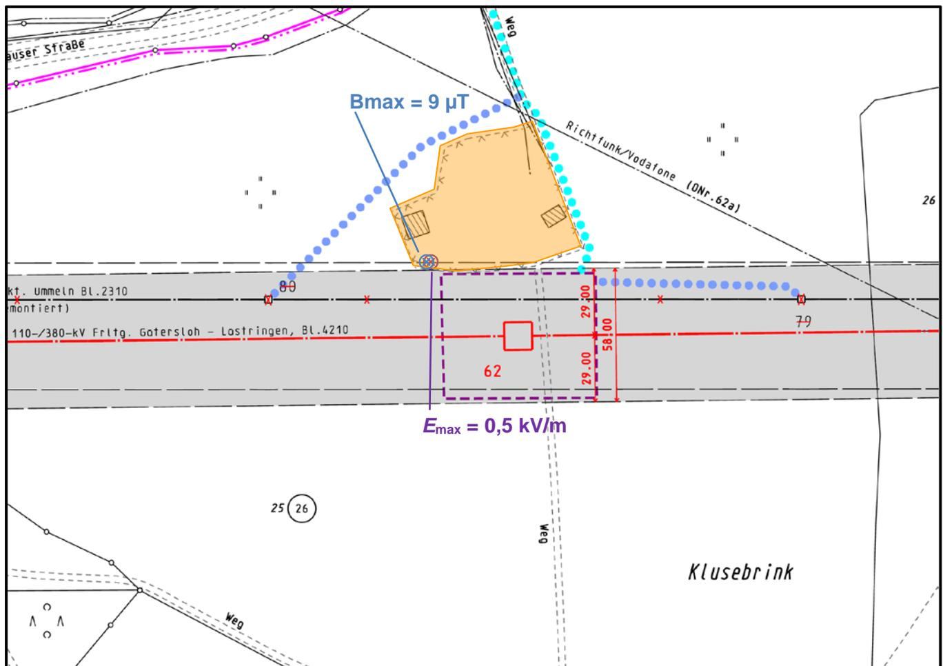
Orte der maximalen elektrischen Feldstärke E und magnetischen Flussdichte B.
