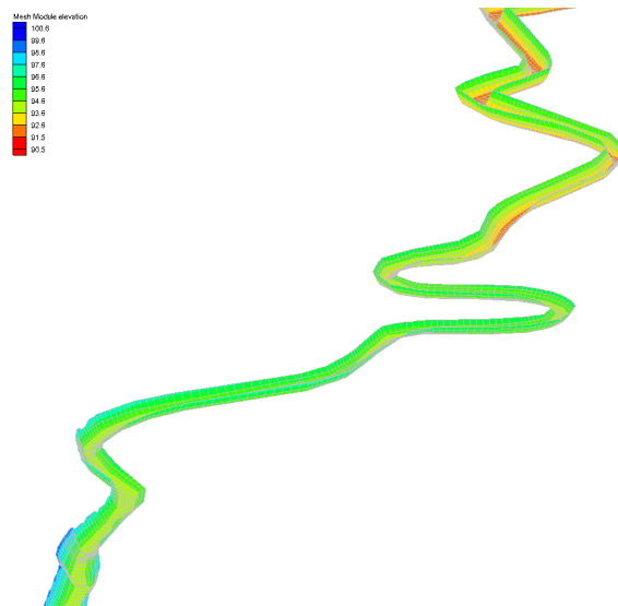
Abbildung 1: Flussschlauchgenerierung aus Querprofilen
