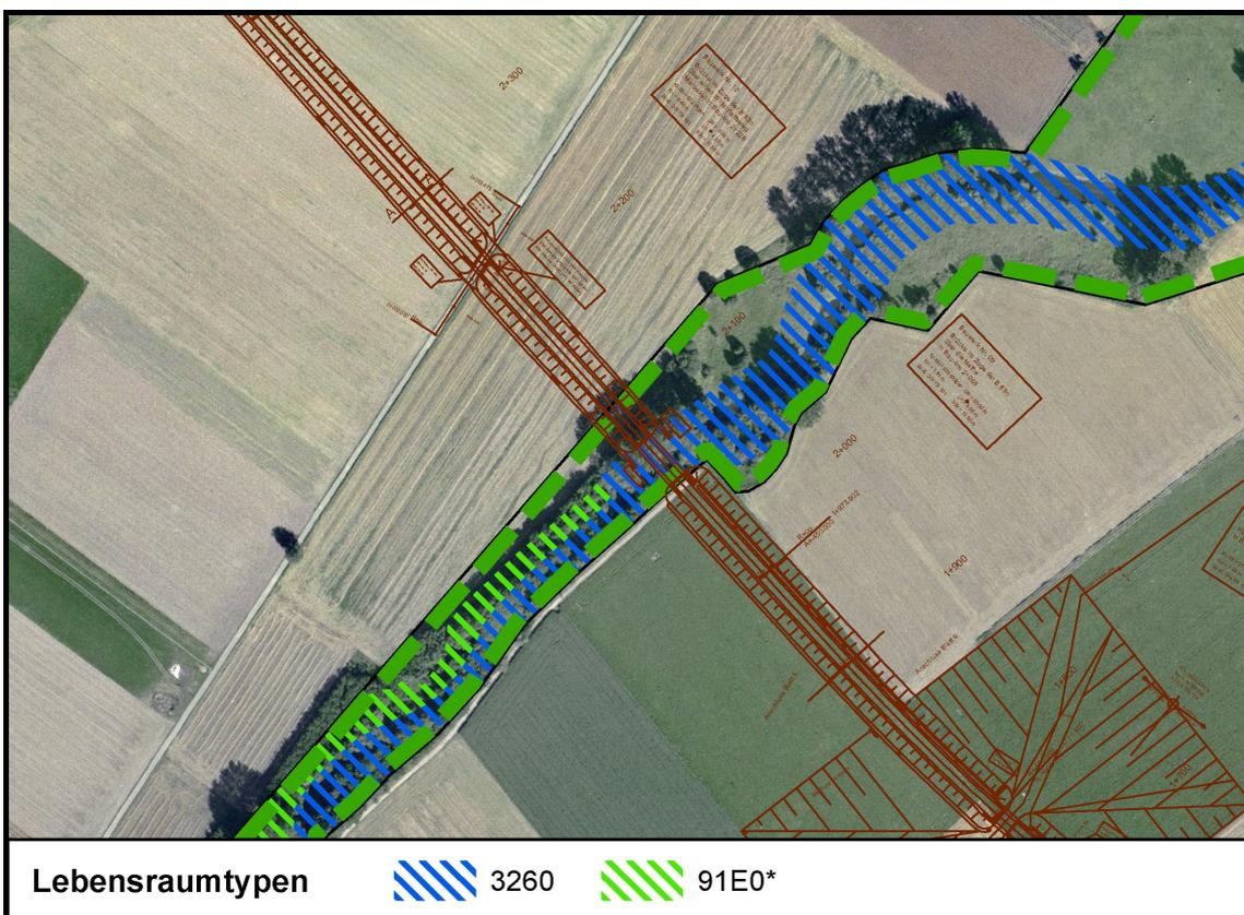
Bei Bau-km 2+067 quert die B 83n außerdem die Nethe, ein Gewässer II. Ordnung, sowie das FFH-Gebiet Nethe mittels eines Bauwerks mit einer lichten Weite von 30 m.
