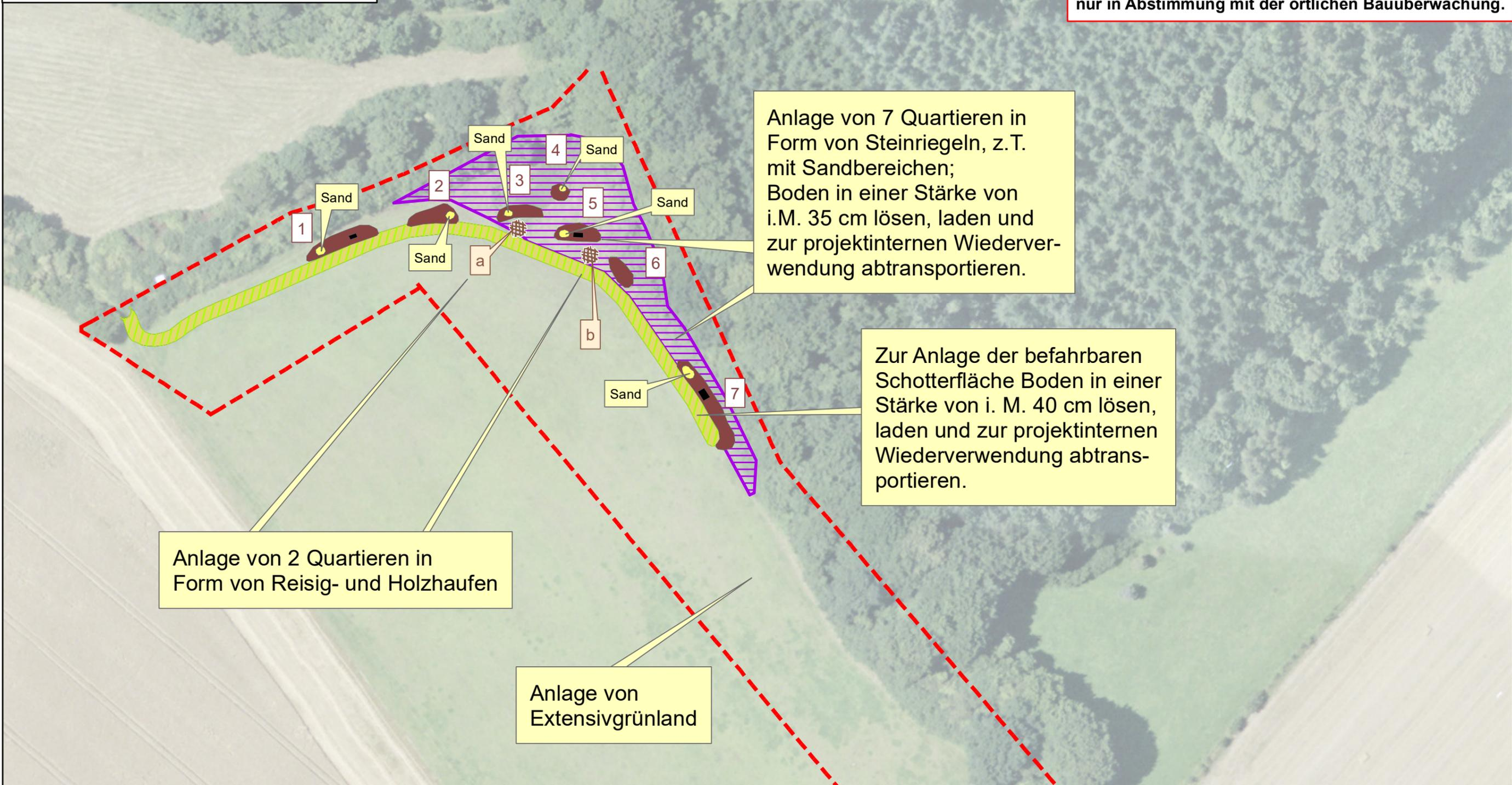
Anlage von 7 Quartieren in Form von Steinriegeln, z.T. mit Sandbereichen; Boden in einer Stärke von i.M. 35 cm lösen, laden und zur projektinternen Wiederverwendung abtransportieren.
