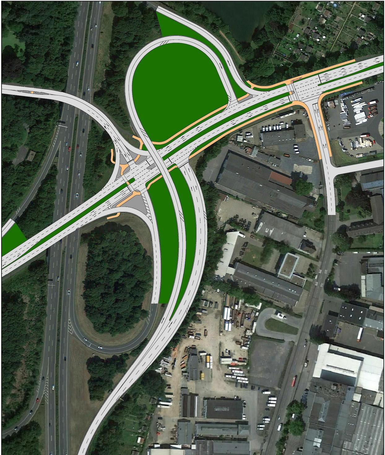
Abbildung 21: Verkehrstechnische Skizze für den zweistreifigen Ausbau der Ausfahrttrampe
