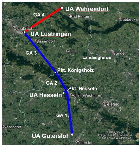
Abbildung 1: Räumlicher Verlauf des EnLAG-Vorhabens Nr.16 mit den vier Genehmigungsabschnitten GA 1 (UA Gütersloh-UA Hessel), GA 2 (Pkt. Hessel-Pkt. Königsholz), GA 3 (Pkt. Königsholz-UA Lüstringen) und GA 4 (UA Lüstringen-UA Wehrendorf)
