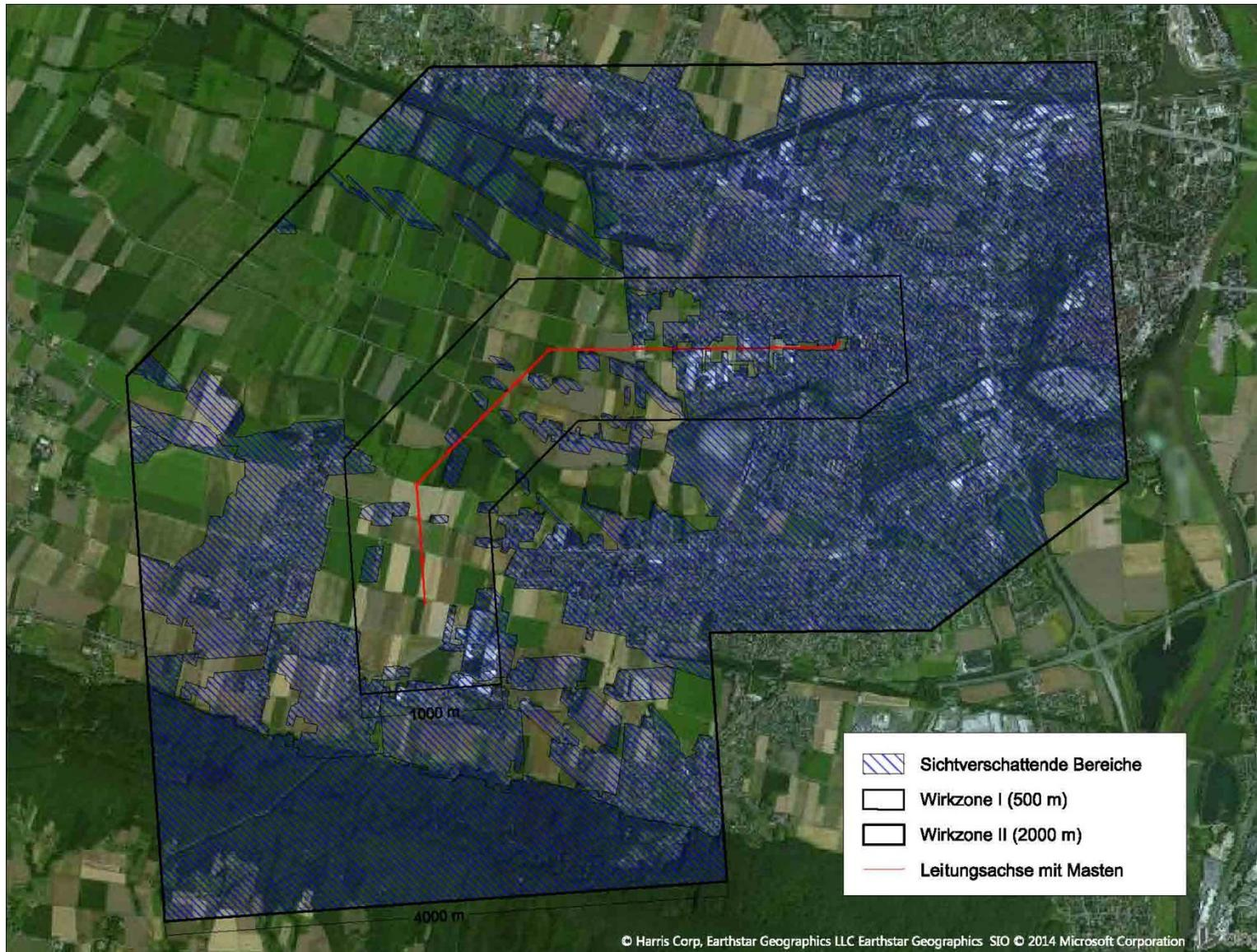
Abbildung 5: Freileitung mit den Wirkzonen I und II nach NOHL (500 m bzw. 2000 m beiderseits der Trasse, eigene Darstellung)
