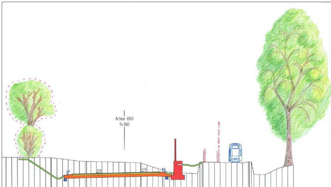
Abb. 25: Kollisionsschutz und Leitstrukturen im Bereich der Flugroute 8 im Bereich des Bahnhofs Godelheim. Rot markierte Gehölze sind neu zu pflanzen.
