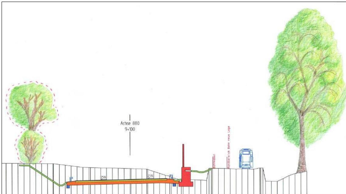
Abb. 25: Kollisionsschutz und Leitstrukturen im Bereich der Flugroute 8 im Bereich des Bahnhofs Godelheim. Rot markierte Gehölze sind neu zu pflanzen.
