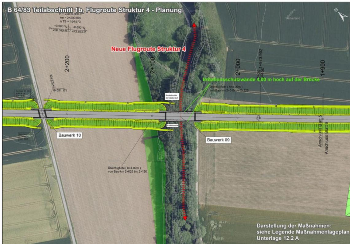
Abb. 73: Vorgesehene Schutzmaßnahmen zu Flugroute Struktur 4 (Nethe)
