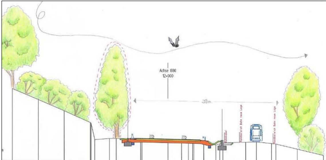
Abb. 6: Querungsmöglichkeit im Rahmen eines „Hop-overs“ im Bereich der Flugroute FR1. Rot markierte Gehölze sind neu zu pflanzen.
