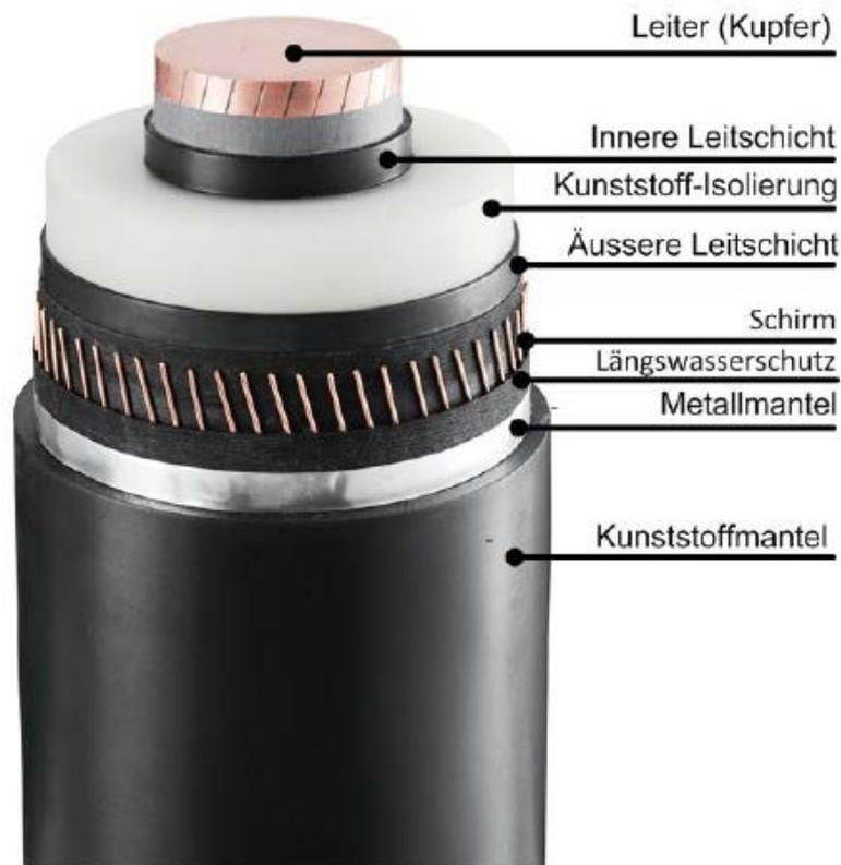
**Abbildung 3:** Querschnitt eines VPE-Kabels
