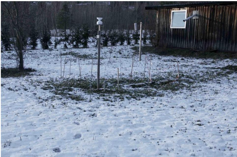
**Abbildung 14: Meßfläche bei einsetzender Tauphase bei Erwärmung der Rohre auf 50°C**
