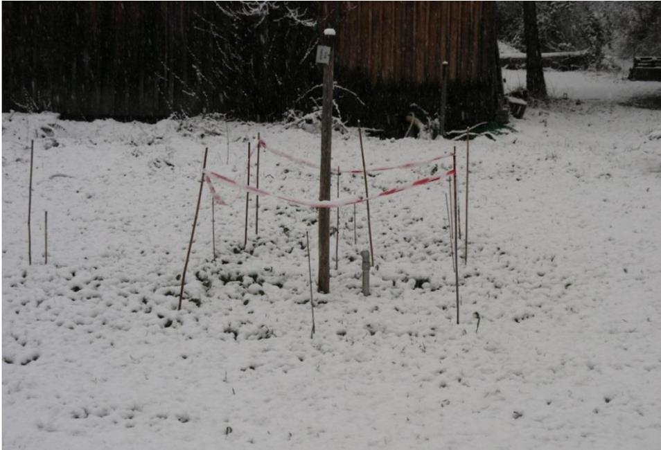
**Abbildung 13: Meßfläche unmittelbar nach Schneefall auf ungefrorenem Boden bei Erwärmung der Rohre auf 50°C**
