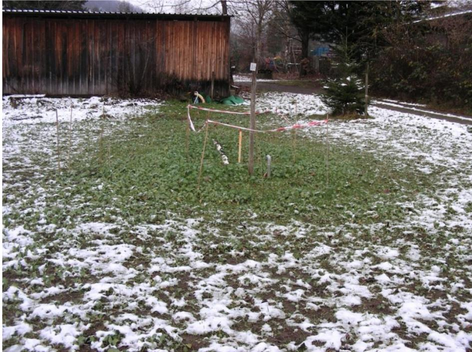
**Abbildung 15: Meßfläche nach fortgeschrittener Tauphase bei Erwärmung der Rohre auf 50°C**
