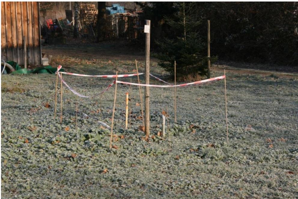
**Abbildung 16: Auftreten von Bodenfrost bei Erwärmung der Rohre auf 50°C**
