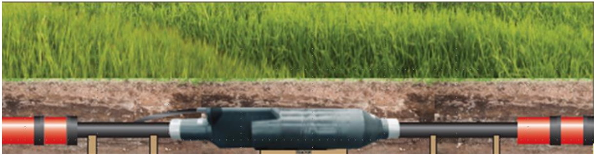
Abbildung 18: Darstellung einer Kabelmuffe
