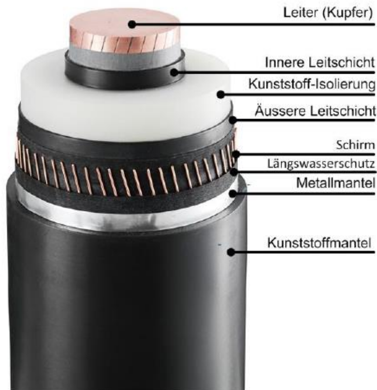
Abbildung 16: Querschnitt eines VPE-Kabel
