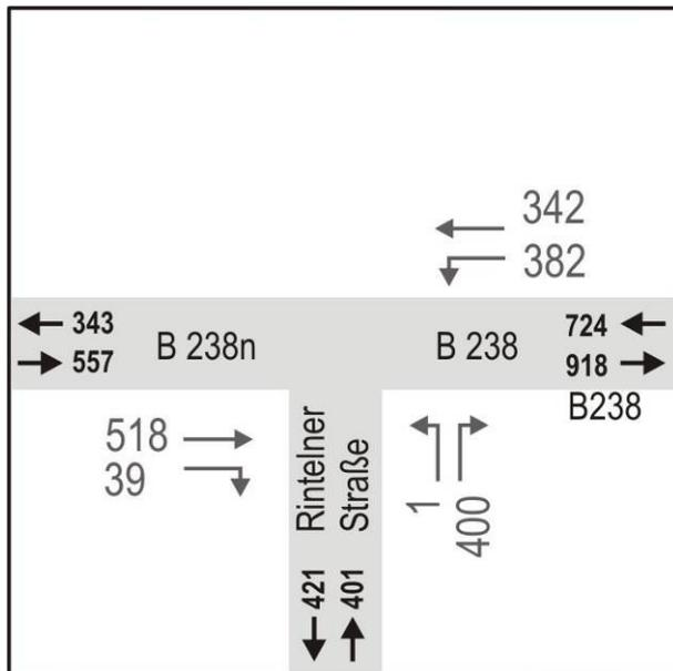
Bild 17: Kfz-Belastung 2030 am Knotenpunkt B 238n/B 238/Rintelner Str.
